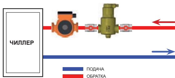
ПРАВИЛЬНАЯ УСТАНОВКА В ОТОПИТЕЛЬНОЙ СИСТЕМЕ
